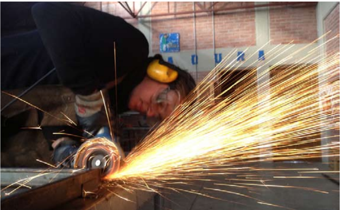
BEARBEITUNG DER RAHMEN FÜR DIE ROLLTORE
